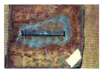
Ein mit Benzin beladener Tanker (Größe 15.000 BRT) hatte Grundberührung. Folge war eine Leckage von 200 mm x 700 mm. Die Reparatur wurde unter Wasser durchgeführt. Verwendet wurde MM-metall UW mit Härter UW9 und einer Blechplatte.
