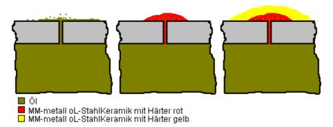
Die Leckage austretenden Öls aus einer Schweißnaht wurde durch den Gebrauch des PolymerMetalls MM-metall oL-StahlKeramik mit Härter rot bzw. Härter gelb beseitigt.
